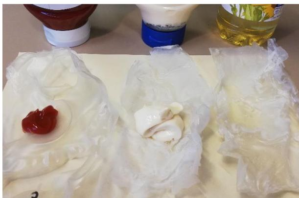
Kontakttest der Prototypen mit Ketchup, Mayo und Öl
