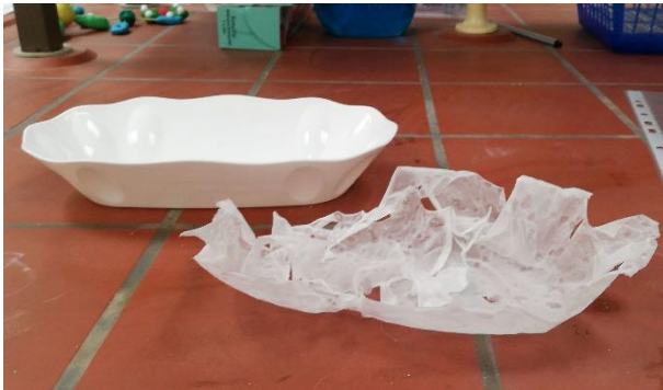
Kurz vor der Aushärtung wird die Folie in eine Form gebracht
