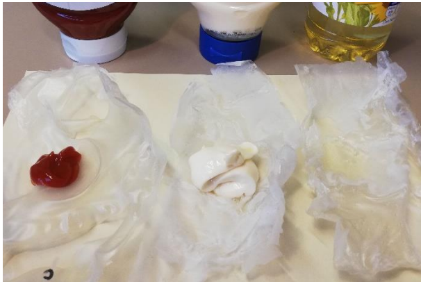
Kontakttest der Prototypen mit Ketchup, Majo und Öl
